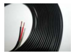
Pour un panneau solaire allant jusqu'à 300W, suffisant pour un bateau standard, il est conseillé de choisir des câbles d'une épaisseur de 2,5mm² et d'une longueur totale jusqu'à 10 mètres.
